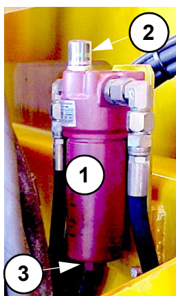
Foto16 Filtro de aceite hidráulico circuito translación
